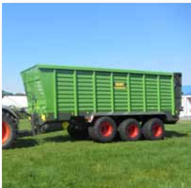
Кузова для транспортировки силоса объемом от 38 до 50 кубометров.
