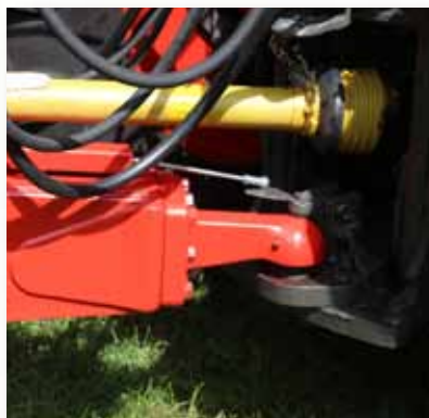
Принудительное управление с помощью троса Боудена.
