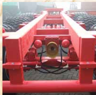
Тридедное шасси с серийным сквозным приводом вала отбора мощности для приводов кузовов.
