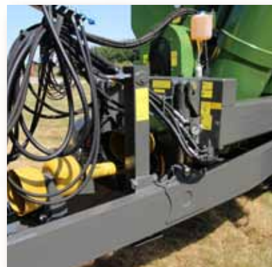
Гидравлическая стойка и гидравлическая амортизация дышла.
