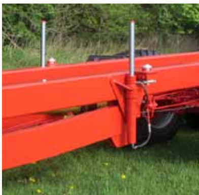
Специальный цилиндр для съема и установки различных кузовов.
