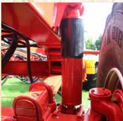
Шасси с гидравлической подвеской.
