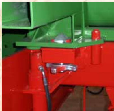
Замок Twist-Lock с креплением для откидных упоров.
