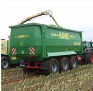
Грузовой кузов с выдвигаемым бортом объемом 40 или 50 кубометров.
