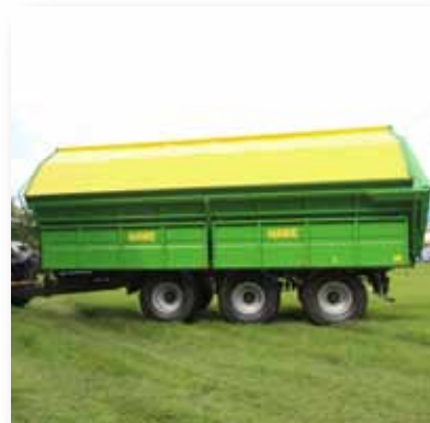
Nástavba vyklápěcího vozu v různých provedeních s objemem od 22 do 44 kubických metrů.
