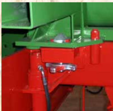
Zajištění Twist-Lock s upevněním pro odstavené opěry.
