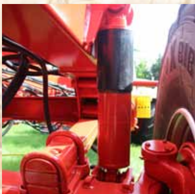
Podvozek s hydraulickým odpružením podvozku.
