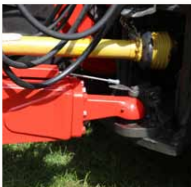
Ovládání nuceného řízení pomocí lanovodu.
