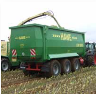
Nástavba nákladního vozu s výtlačným čelem s objemem 40 nebo 50 kubických metrů.
