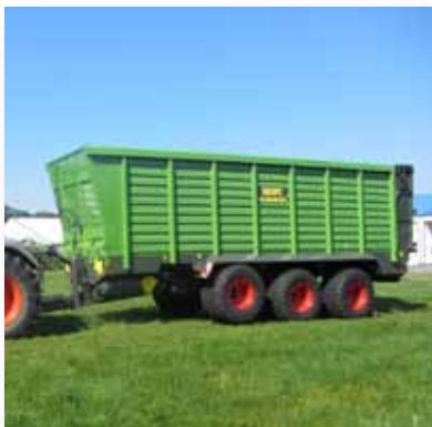
Nástavba transportního vozu na siláž s objemem 38 až 50 kubických metrů.
