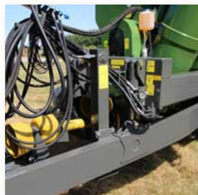
Hydraulicky ovládaná podpěrná noha a hydraulické odpružení tažné oje.
