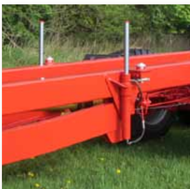
Zvedací válce pro odstavení a upevnění různých nastaveb.
