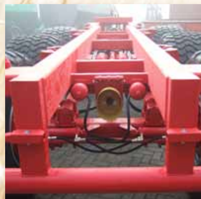
Třínápravový podvozek se sériovým pohonem vývodovým hřídelem pro pohony nastaveb.
