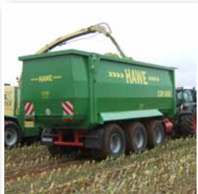
Caisse des remorques Cargo à fond poussant avec un volume de 40 ou 50 m 3 .
