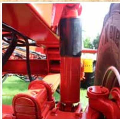
Châssis avec suspension hydraulique.
