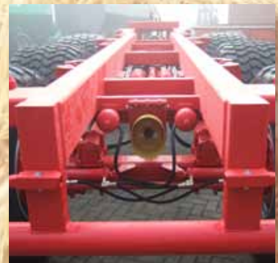
Tridem-Fahrwerk mit serienmäßigem Zapfwellendurchtrieb für die Antriebe der Aufbauten.
