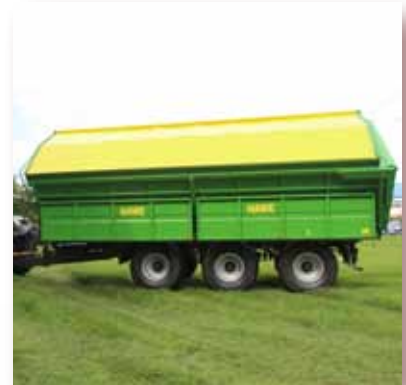
Muldenkipper-Aufbauten in verschiedenen Varianten von 22 bis 44 Kubikmetern.
