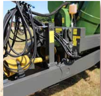
Hydraulischer Stützfuß und hydraulische Deichselfederung.
