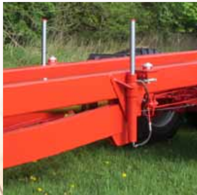
Aushebezylinder zum Abstellen und Aufnehmen der verschiedenen Aufbauten.
