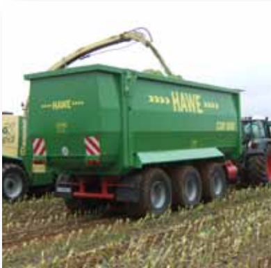
Cargo Abschiebewagen-Aufbau mit 40 oder 50 Kubikmetern Volumen.
