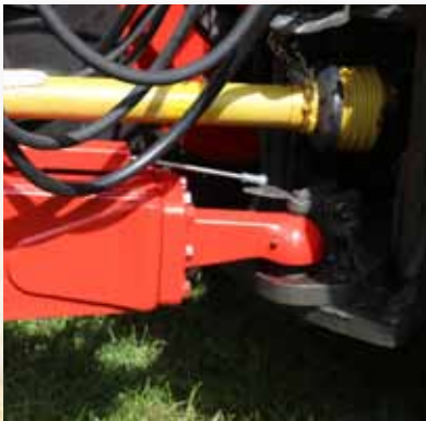
Ansteuerung der Zwanglenkung durch Bowdenzug.
