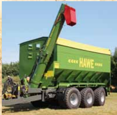
Überladewagen-Aufbauten für Getreide von 25 bis 38 Kubikmetern.
