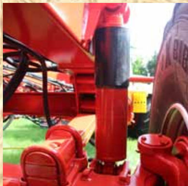
Fahrwerk mit hydraulischer Fahrwerksfederung.
