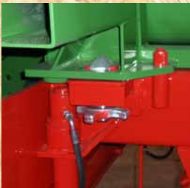
Twist-Lock Verriegelung mit Aufnahme für die Abstellstützen.
