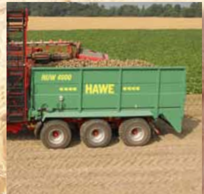
Rübenüberladewagen-Aufbauten mit 28 (Tandem) und 40 Kubikmetern (Tridem).
