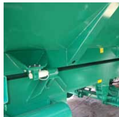
Vážicí tyče pro váhové zařízení nebo integrované v hydraulickém podvozku (volitelná výbava).
