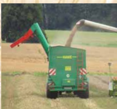
Hydraulicky otočný šnekový dopravník osiva a hnojiva pro secí stroje a rozmetadla.
