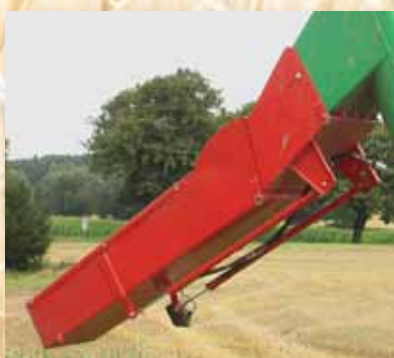
Hydraulicky přestavitelný skluz osiva a hnojiva pro velké secí stroje a rozmehnojiv s velkými pracovními záběry.
