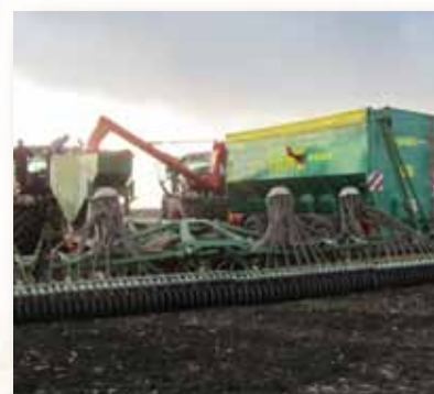
Přídavné využití překládacích vozů při hnojení. Plnění velkých rozmetadel zvyšuje výkonnost a šetří čas.
