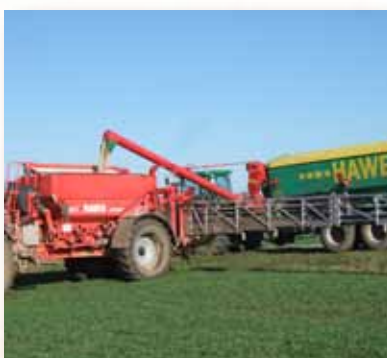
Přídavné využití překládacích vozů při hnojení. Plnění velkých rozmetadel zvyšuje výkonnost a šetří čas.
