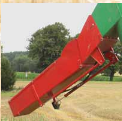
Гидравлически регулируемый желоб для посевного материала и удобрений для больших рядовых сеялок и разбрасывателей удобрений.
