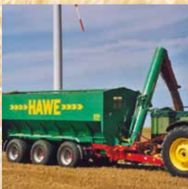
Гидравлически складываемые шнеки для подачи посевного материала и удобрений в рядовые сеялки и разбрасыватели удобрений с большой рабочей шириной.
