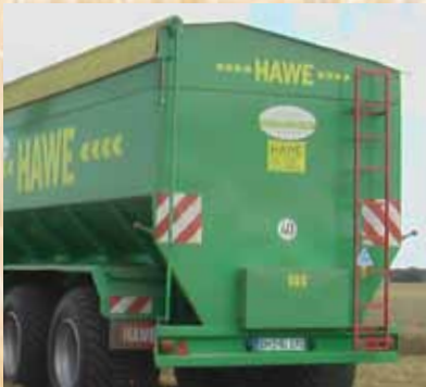
Легкодоступная рукоятка для закрытия прицепа сверху тентом в серийной комплектации.
