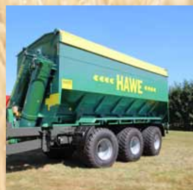
... или с тридеммным шасси (серийная комплектация).
