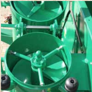
Большой диаметр шнека с опорой в форме звезды.
