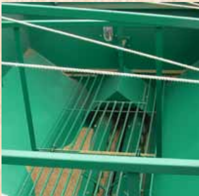
Перегрузочные шнеки в прицепе.
