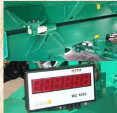
Стержни весов, интегрированные в ходовую часть с гидроприводом (опции).
