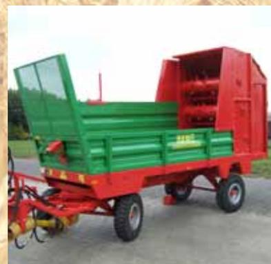
Für enge Stalleinfahrten bietet HAWE 2-Achs-Fahrwerke für Typen mit Hintenentleerung an.
