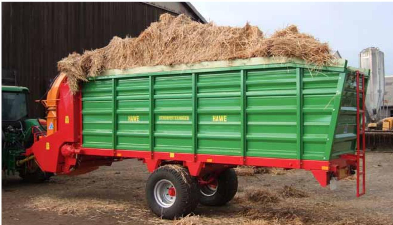
An die Strohverteilerwagen werden die unterschiedlichsten Anforderungen gestellt. HAWE Wester bietet Ihnen kompakte, extra schmale Fahrzeuge mit großer Ladekapazität für leistungsfähige Auflösung, Zerkleinerung und Verteilung von Rund- und Quaderballen. Mit nur 1,60 Meter Breite können auch
