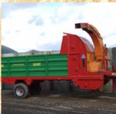
HAWE SVW II RWG mit Ladenvolumen für 4 Quader- oder 3 Rundballen.
