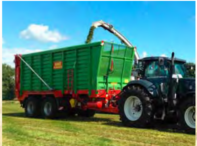
Прицеп для силоса HAWE SLW 45 TN, двухосный, объем: 42 м 3 Прицеп для силоса HAWE SLW 45 TL, двухосный, объем: 45 м 3
