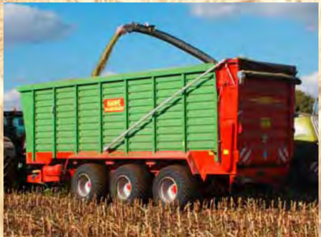
Прицеп для силоса HAWE SLW 50 TN, трехосный, объем: 50 м 3
