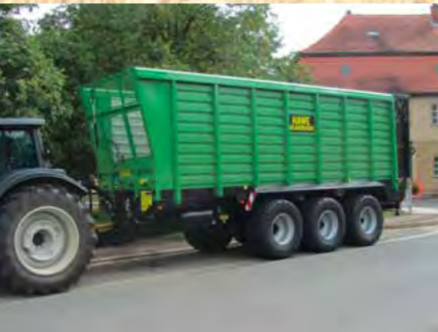
Прицеп для силоса HAWE SLW 45 TN, трехосный, объем: 45 м 3
