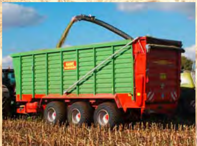
HAWE Silagewagen SLW 50 TN, Tridemachse, Volumen: 50 m 3
