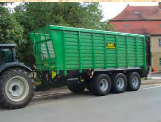
HAWE Silagewagen SLW 45 TN, Tridemachse, Volumen: 45 m 3
