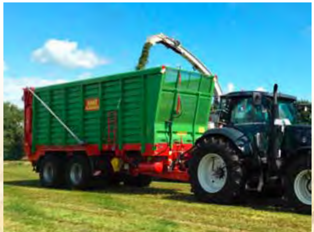
HAWE Silagewagen SLW 45 TN Tandemachse, Volumen: 42 m 3 HAWE Silagewagen SLW 45 TL, Tandemachse, Volumen: 45 m 3
