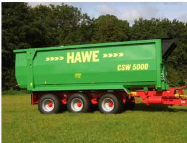
с невысоким потолком. Кроме того, такой метод разгрузки гораздо безопаснее на слонах: центр тяжести прицепа находится ниже, за счет этого уменьшается опасность переворачивания. Устойчивая корпусная конструкция рассчитана на высокие нагрузки.
