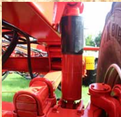
Fahrwerk mit hydropneumatischer Fahrwerksfederung, inklusive Liftachse.
