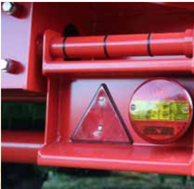
Pendelnd aufgehängte Rückleuchten (Schutzgitter als Zubehör).
