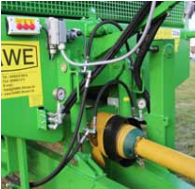
Zugdeichsel, hydropneumatisch gefedert mit Untenanhängung.
