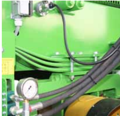
Zugdeichsel, mechanisch gefedert mit Oben-/Untenanhängung.
