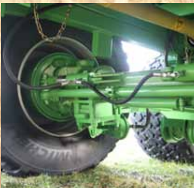
Nachlauf-Lenkachse hydraulisch sperrbar mit automatischer Ausrichtung für optimalen Geradeauslauf.
