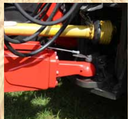
Ansteuerung der Zwangslenkung durch Bowdenzug.
