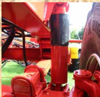
Fahrwerk mit hydropneumatischer Fahrwerksfederung, inklusive Liftachse.
